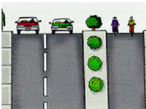
Figura 7. Ciclovía. Los ciclistas tiene un carril exclusivo separado del de vehículos por una barrera física
