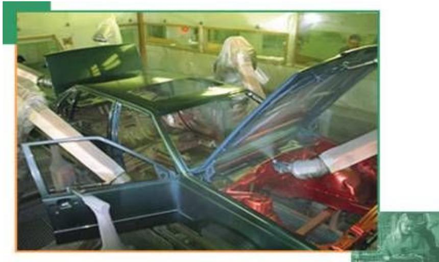
En estos procedimientos se cubre una superficie (de forma tridimensional y en general complicada) con una mezcla de aire y material pulverizada mediante una pistola. Es preciso conseguir una perfecta homogeneidad en el reparto de la pintura, realizándose para ello un control de la viscosidad, de la distancia entre las piezas y la pistola, de la velocidad de movimiento de ésta, del número de pasadas etc. Todos estos parámetros son tradicionalmente controlados por el operario.
