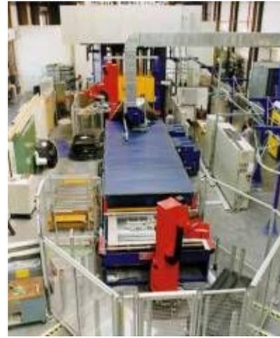
Si bien el oxicotante y el corte por plasma son tecnologías muy extendidas, y consecuentemente bien conocidas, no ocurre lo mismo en el corte por láser y por chorro de agua, de más reciente aparición. La disposición típica del robot en el corte por chorro de agua es el robot suspendido trabajando sobre las piezas fundamentalmente en dirección vertical.
