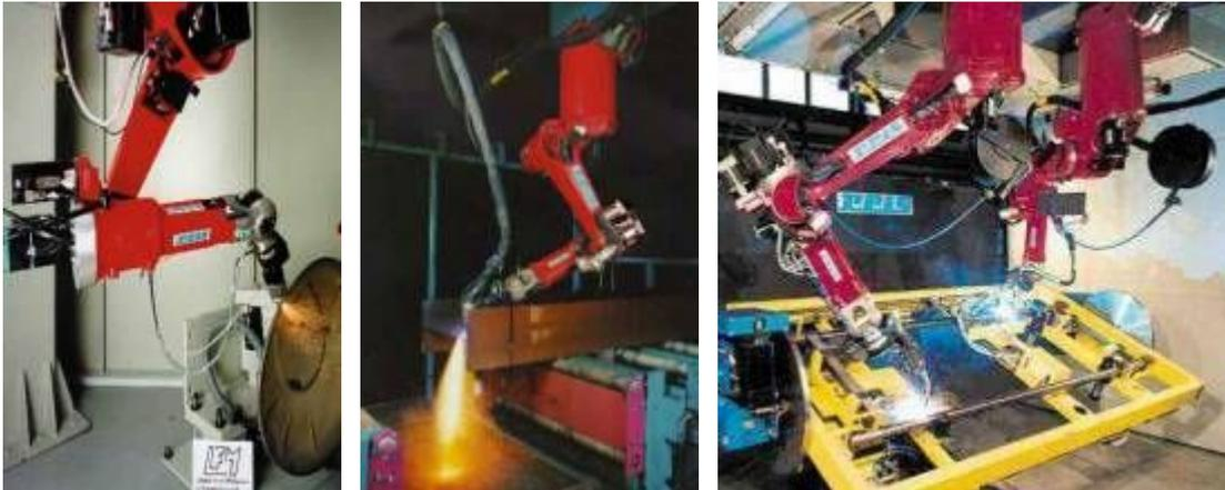
La robotización de la soldadura por puntos admite dos soluciones: el robot transporta la pieza presentando ésta a los electrodos que están fijos, o bien, el robot transporta la pinza de soldadura posicionando los electrodos en el punto exacto de la pieza en la que se desea realizar la soldadura. El optar por uno u otro método depende del tamaño, peso y manejabilidad de las piezas.
