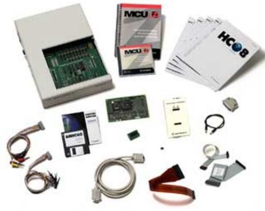
El kit modular KITMMEVS de 1.495\$ es un emulador en tiempo real completo, con emulación en-circuito para todos los tipos de microcontroladores de la familia 68HC05 y 68HC08. Basado en una placa base, un módulo de personalización, un cable y la punta de emulación. Este equipo también incluye un emulador ICS.
