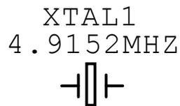
Figura 30. Cristal Resonador de Cuarzo. Proporciona pulsos de sincronía para el microcontrolador.
