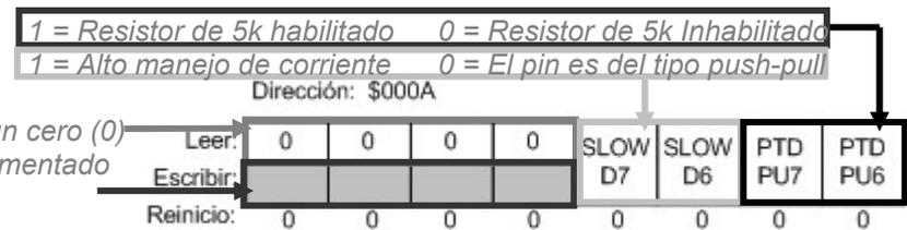
Figura 96. Registro de Control del Puerto D. Habilita ó deshabilita la capacidad de alto manejo de corriente de los puertos SLOWD7, SLOWD6; habilita ó deshabilita los resistores internos de pull-ups a 5k del puerto.
