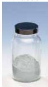
Frasco es el típico recipiente cerrado para polvos. Se diferencia de las botellas en que la boca es más ancha para que se pueda introducir una cuchara o una espátula para extraer sólidos en polvo, gránulas, etc.. Un frasco típico de vidrio con tapa a rosca de plástico, es el que se ve en la Figura N° 5. Los frascos vienen en tamaños desde 150 – 200 mL hasta de varios litros de capacidad. Si bien antiguamente se usaban los tapones a presión de madera, corcho o goma, actualmente se ha pasado a
