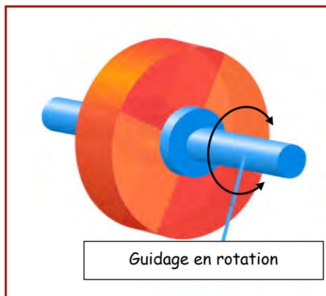
La liaison et le guidage permettent de supprimer les possibilités de mouvement qui entraveraient le bon fonctionnement d'un mécanisme ou d'un objet.
