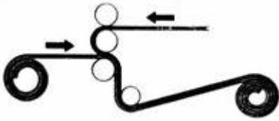
Un caso particular de aplicación de calandrado es el **laminado**, que consiste en recubrir, con un film de plástico, una lámina de otro material.
