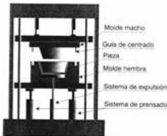
Las prensas suelen ser hidráulicas, y se pueden equipar con platos de calefacción que transmiten su calor a los moldes.
