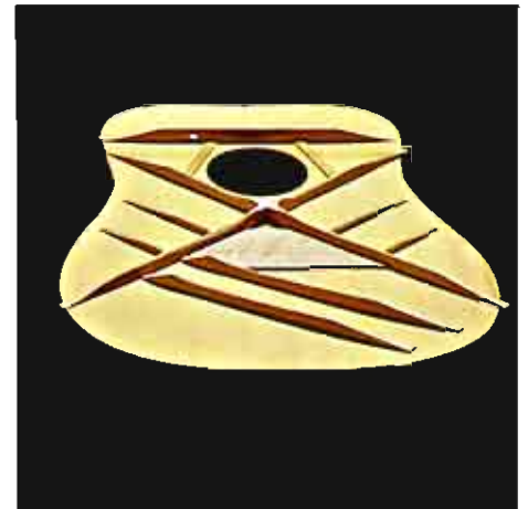
Refuerzos en el interior de la tapa de una Ibanez
