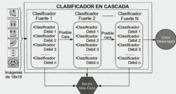
Figura 3. Estructura del sistema clasificador en cascada.
