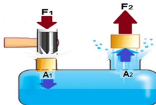
Figura 11: Principio de Pascal. Rediseñada de <http://lafisicaparatodos.wikispaces.com/PRINCIPIO+DE+PASCAL>
