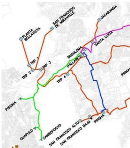
Aprovechamiento de infraestructura para conducción de agua potable proveniente de la Planta de Tratamiento de Agua Bellavista en generación hidroeléctrica. Se instalarán dos mini centrales de 250 kW y 350 kW, conectadas directamente al sistema de distribución para aumentar la confiabilidad del servicio y reducir las pérdidas técnicas. Se cuenta con los diseños definitivos y su construcción concluiría para abril de 2016.
