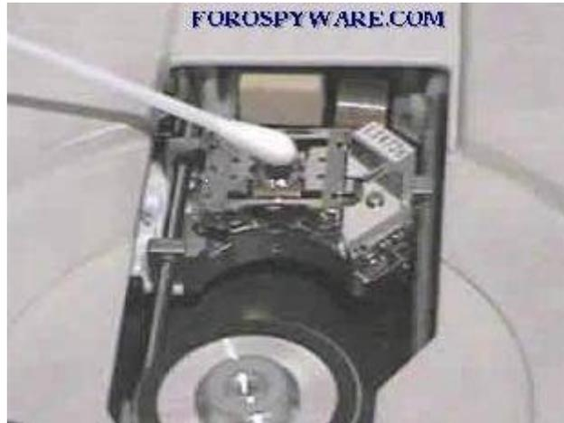
Para lubricar los rieles antes de todo los limpiaremos, para ello utilizaremos un solvente (kerosén, Eurosolv-1000, aguarrás o alcohol), humedecido en un trapo. Cuando ya terminamos de limpiar, lubricaremos los rieles y los piñones plásticos.
